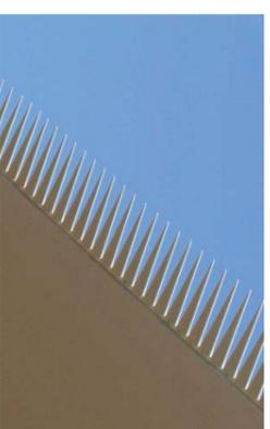
Photographies d'une pale dotée d'un système TES (peigne / dentelure)
